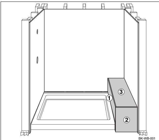
5. Aplique una capa de imprimador/sellador acuoso u oleoso sobre todas las superficies de la placa de cemento o greenboard (siga las instrucciones del fabricante). Deje que el imprimador seque bien antes de colocar la silicona transparente.
