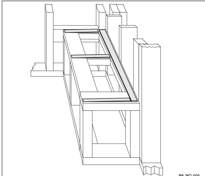
4. Coloque una placa de cemento o greenboard resistente a la humedad sobre todas las superficies del área correspondiente al asiento (1, 2 y 3). Siga las recomendaciones del fabricante de los paneles de pared respecto de la instalación.
